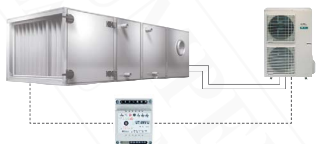
Lüftungsanlage mit INV-Modul
