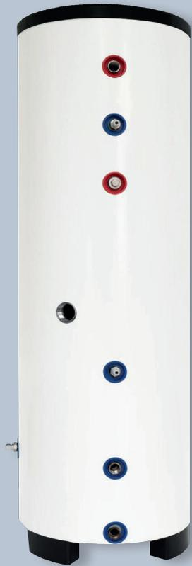
Der Wärmepumpen-Brauchwasserspeicher hat ein Volumen von 300 Litern und ist im Kern aus hochwertigem Edelstahl [Duplex 2205] gefertigt. Der Außenmantel besteht aus galvanisiertem und lackiertem Stahl. Dank der 50 mm PU-Hartschaumisolierung erreicht der Speicher die Effizienzklasse A nach EN 12977-3:2012.
