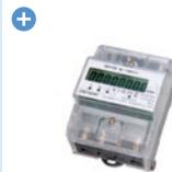
**Drehstromzähler** zur Kombination mit EME 20 Direktmessender elektronischer Drehstromzähler mit 8-Segment-LC-Display mit S0-Impulsausgang zur Messung des Eigenverbrauchs in Verbindung mit dem Zubehör NIBE EME 20. Geeignet für Ströme bis max. 3x20 A.
