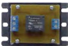
Die Zusatzplatine PFEA-FAN DC bietet für die Panasonic PACi und VRF-Inneneinheiten die Möglichkeit zur Ansteuerung eines ext. Ventilators über die Fernbedienung der Inneneinheit. Die Zusatzplatine wird an den FAN DRIVE Stecksockel auf der Steuerungsplatine der Inneneinheit angeschlossen.
