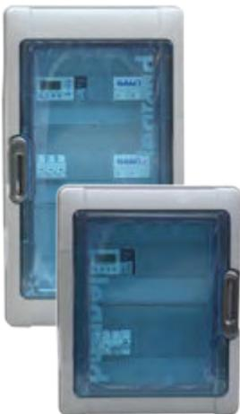
Grundlastumschaltung mit Störungs- und Raumtemperaturüberwachung inkl. vorprogrammierter elektronischer Jahreszeitschaltuhr für gleichmäßigen Betrieb der Systeme. Gehäuse IP55 mit Klarsichttür. Betriebs-, Alarm- und Sammelstörung mit Wechselkontakt. Für den Anschluss an Mono-Split und VRF-Systeme.
