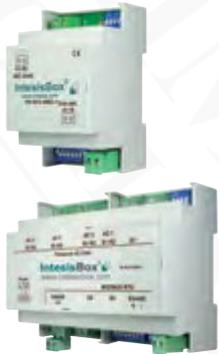
Das Interface PAW-RC2-MBS-1 bzw. PAW-RC2-MBS-4 ermöglicht die bidirektionale Überwachung und Steuerung aller Funktionsparameter von Panasonic ECOi- und PACi Inneneinheiten in Modbus RTU (RS-485) Netzwerken.
