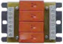
Die Zusatzplatine PFEA-8A bietet für die Panasonic VRF-Außeneinheiten die Möglichkeit einer externen Betriebsartenumschaltung. Die Zusatzplatine wird an den MODE Stecksockel auf der Steuerungsplatine der Außeneinheit angeschlossen.
