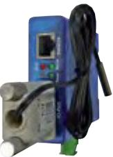
Das Web-Thermometer ist ein Messgerät welches Temperaturen erfasst und die Werte im Netzwerk zur Verfügung stellt. Das Gerät verfügt über einen integrierten Datenlogger und über zahlreiche Web- und Netzwerkdienste zur manuellen Abfrage der Messwerte, oder selbstständigem Versand von Meldungen.
